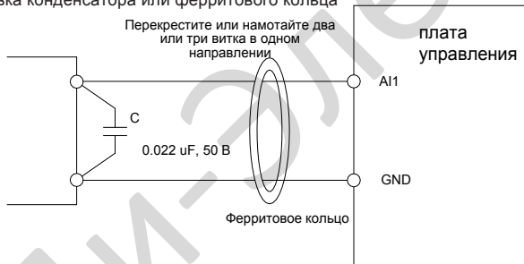
Рис. 3-18 Установка конденсатора или ферритового кольца
