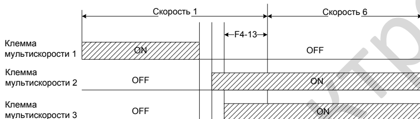
Рис. 6-7 Схема переключения мульти-скоростей
